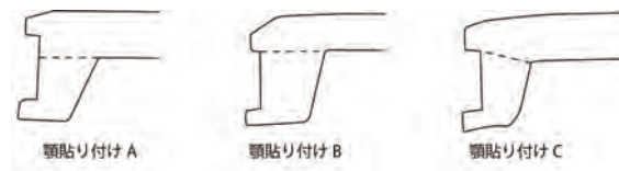
図4 瓦当部の成形方法の模式図
