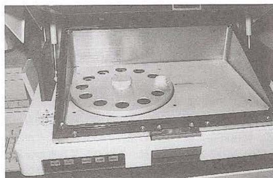
ケイ光X線分析装置(真空対応の試料台)
