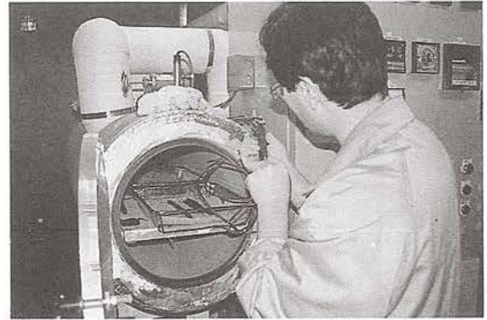
8. 温度モニター用木片設置
