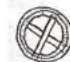
排水のための竹筒を内側から見る 中のアユが逃げないように筒の中に竹の棒をクロスさせてはめ込んである。
