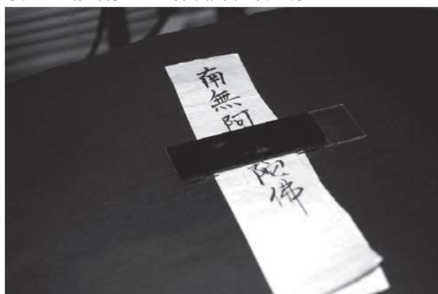
写真12 赤外線の漆膜透過実験（可視光で撮影）
