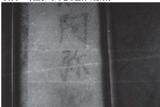
写真11 赤外線の和紙透過実験（赤外線画像）
