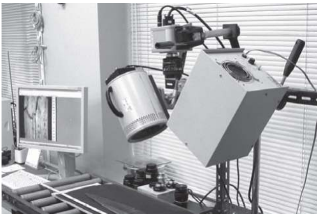
写真21 赤外線デジタルカメラによる観察
