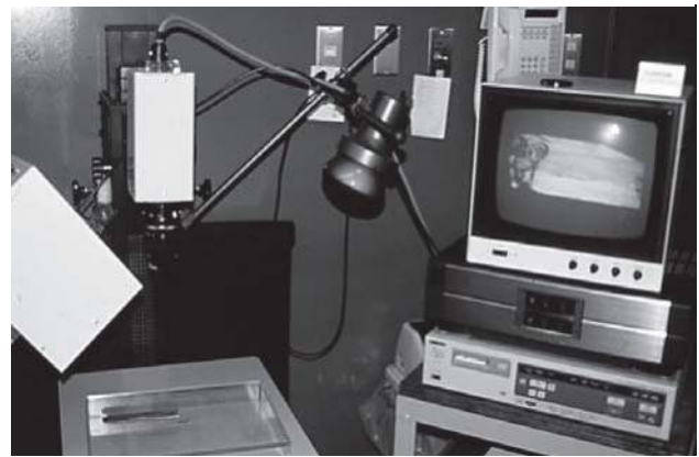
写真20 赤外線ビジコンカメラによる観察
