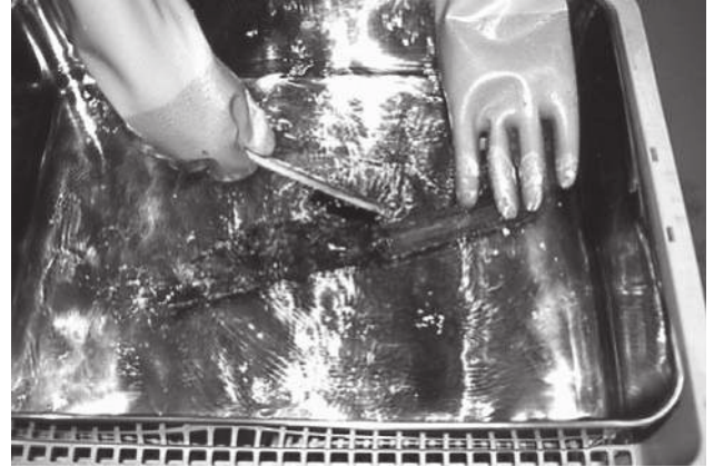
写真12. 柄付き包丁の洗浄（高級アルコール法）
