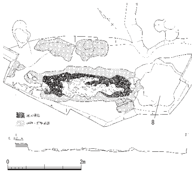
図8 源内峠遺跡4号製鉄炉 (平面図の番号は図9の番号に対応)
