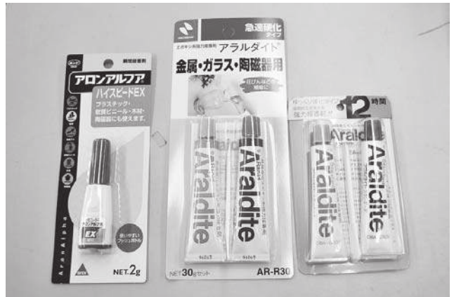
写真14 欠損部への充填剤
