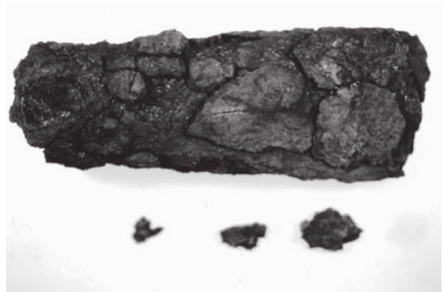
写真 20 鑄造鉄斧の崩壊
