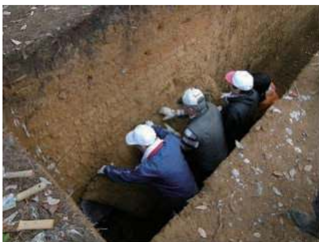
△接着剤が固まった後、土層を剥ぎ取る
