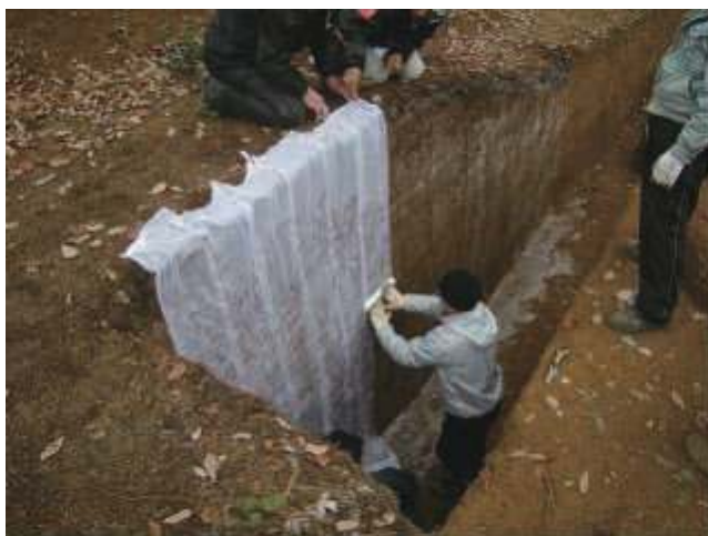
△接着剤を塗布後、ガーゼで裏打ちする
