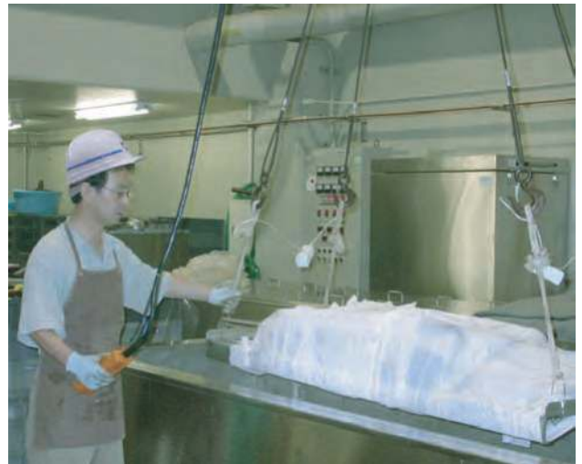
井戸杵材をPEG含浸装置の中に入れる
