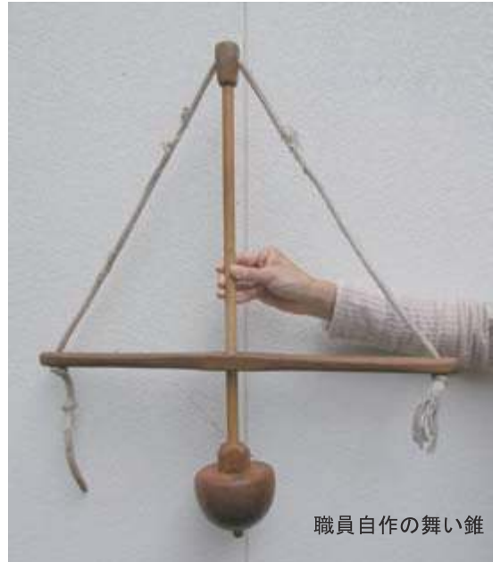
分割して上から芯を差込み、軸で芯を押さえ込む仕組み。
