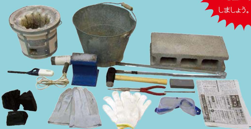
七輪 / バケツ / コンクリートブロック / ライター / ドライヤー / 鉄床 / ハンマー / はさみ / 砥石 / 長いペンチ / 五寸釘 / 炭 / 革手袋 / 軍手 / ゴーグル / 新聞紙
